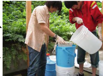
目合 100 μm フランウトンネットで海水を濾す
